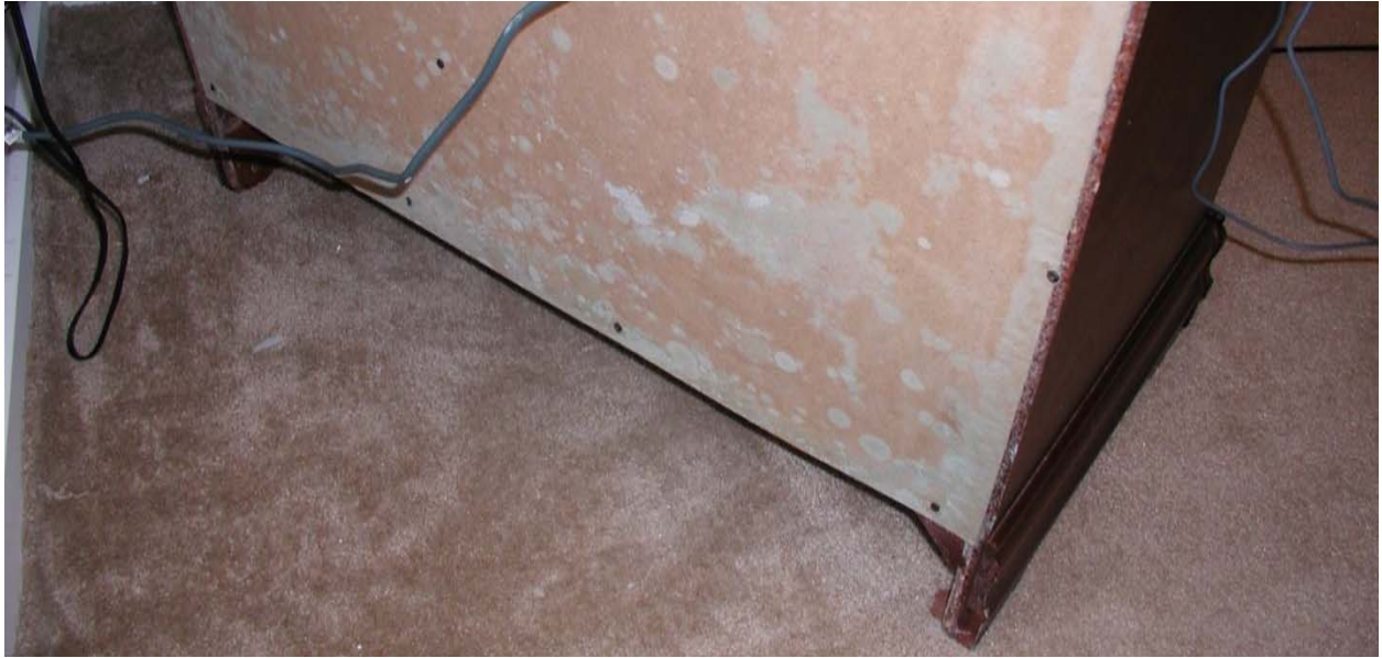
Figura 4. Condensación: los arrendatarios mantenían el apartamento a una temperatura de 60 °F, lo suficientemente fría para hacer que la parte posterior de la cómoda quedara por debajo del punto de condensación, que es la temperatura a la cual los niveles típicos de humedad del aire se condensan en una superficie. Debido a la humedad constante en la cómoda, se produjo y creció el moho. Es posible que baste fregar el mueble para limpiarlo, y luego pintarlo (¡afuera!). Para evitar que el moho vuelva a producirse, las superficies deben mantenerse a una temperatura más alta, bien sea aumentando la temperatura del apartamento mismo y/o permitiendo que el aire circule detrás de la cómoda, o reduciendo la humedad relativa en este espacio.
